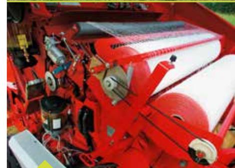
По гофрированной распределительной трубе подается сетчатый материал, который накрывает рулон сверху и по краям.
