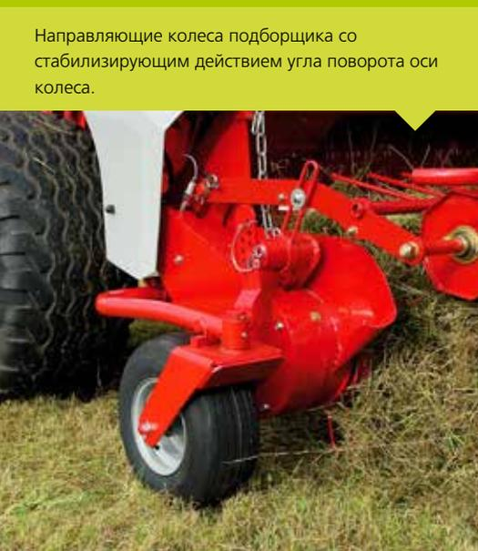
Направляющие колеса подборщика со стабилизирующим действием угла поворота оси колеса.
