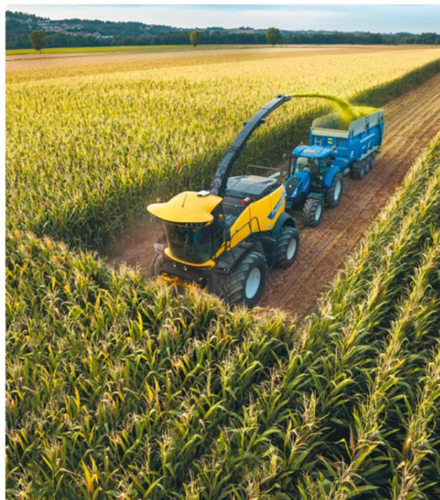
Оборудован 4-х скоростной гидростатической системой, которая позволяет передвигаться по дорогам со скоростью до 40 км/ч
