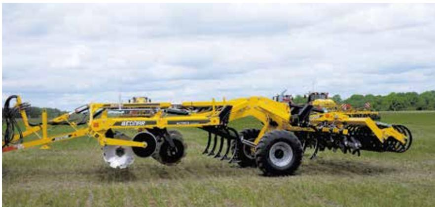
**Предпосевной культиватор Swifter — флагман линейки техники Bednar.** Задача орудия — за один проход вне зависимости от сложности поля подготовить посевное ложе к посеву любой культуры. Культиватор работает на трех катках — передний планчатый каток и задние двойные Crosskill катки. Внутренняя рабочая секция позволяет очень точно копировать контур почвы — за это качество его даже называют «утюгом». Орудие может работать на скорости от 10 до 16 км/ч и выполнять до 8 операций за один проход.
